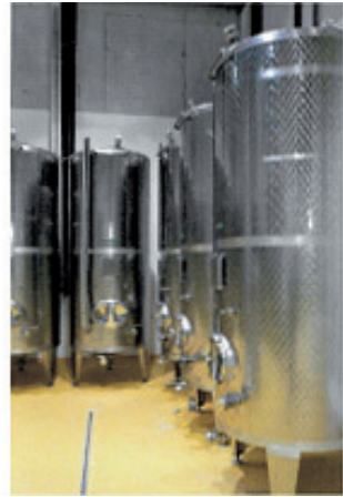
უჟანგავი ჭურჭელი ცილინდრული შესრულებით. ორმაგი პერანგის გამაცივებელი
