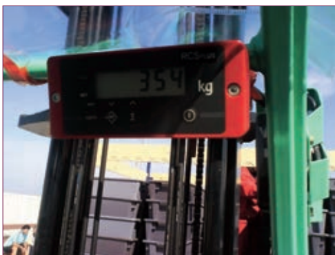
სურათი 8.2. შებრუნებით ჩაწყობადი კონტეინერების შიდასაწარმოო გადაზიდვა და იმავდროული აწონვა
