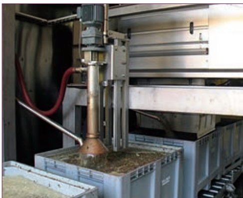
სურათი 8.13ა. წვეთის სინჯის ავტომატიზებული აღება
