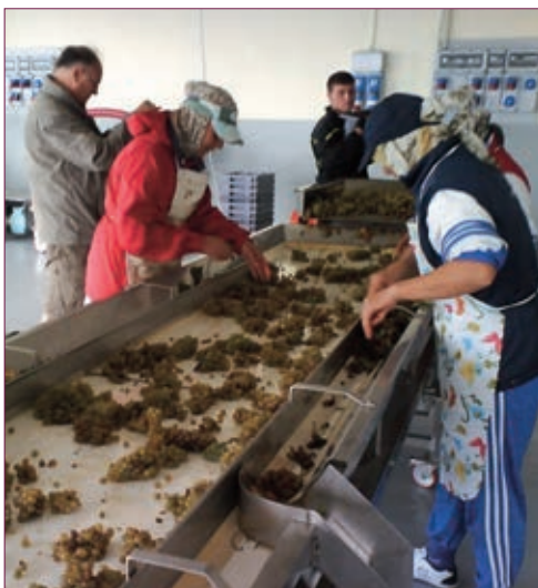
სურათი 8.21. ვიბრაციული კონვეიერი ყურძნის გადარჩევისათვის
