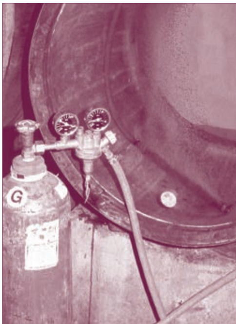
სურათი 8.74. ნახშირმჟავას გამოდევნა აზოტით
