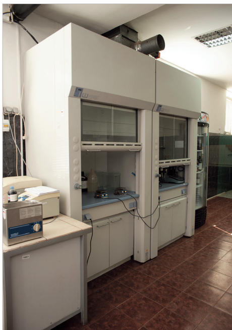
სურათი 17: ამწოვი კარადა / Fume Hood or Fume Cupboard
