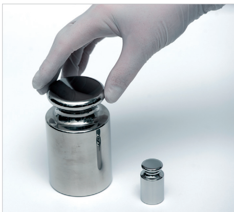
სურათი 7: სასწორის დასაკალიბრებელი საწონები / Calibration Weights (F1 სიზუსტის კლასი)
