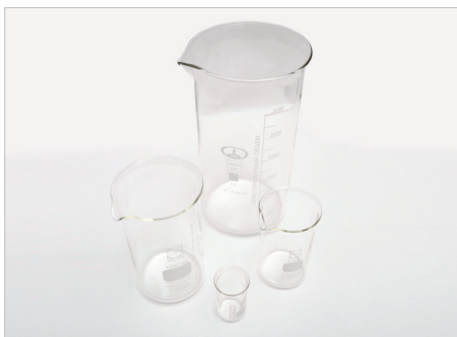
სურათი 32: ქიმიური ჭიქები / Beakers (სხვადასხვა მოცულობის, 50 მლ - 2000 მლ)
