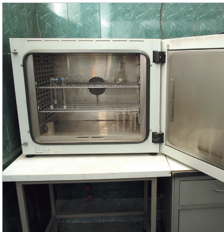
სურათი 22: ჭურჭლის საშრობი კარადა / Drying Cabinet for Laboratory Glassware
