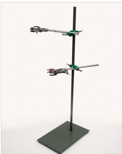
სურათი 23: ლაბორატორიული შტატივი სამაგრებით და მომჭერებით / Laboratory Stand with Clamps and Sleeves
