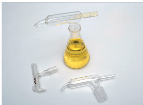
სურათი 31: მინის ადაპტორები / Glassware Adapters (5 მლ, 10 მლ, 20 მლ)
