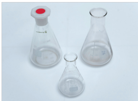
სურათი 29: კონუსური (ერლენმეიერის) კოლებები / Erlenmeyer Flask (100 მლ, 300 მლ, 500 მლ)
