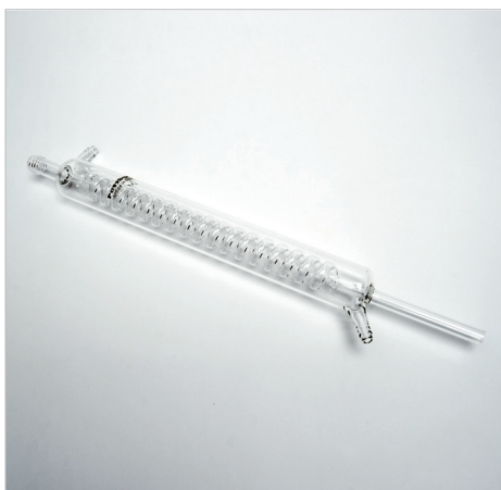
სურათი 27: უკუმაცივარი / Glass Backflow Condenser (შაქრებისთვის; 40 სმ-იანი სიგ- რძის გარსით)
