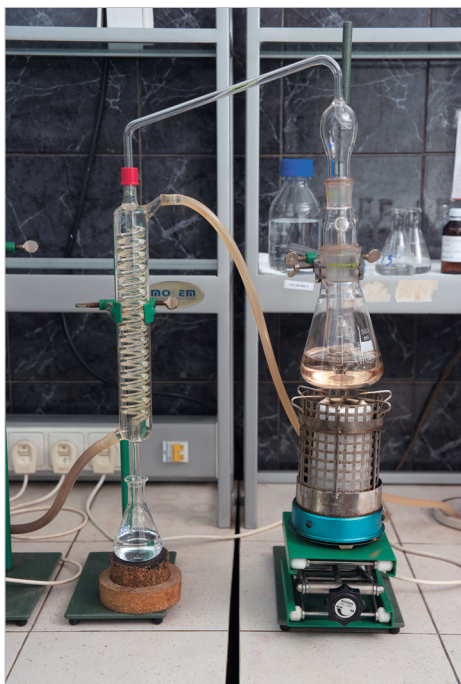
სურათი 25: აქროლადი მჟავების გამო- სახდელი მინის მოწყობილობა / Glass Apparatus for Steam Distillation of Volatile Acids
