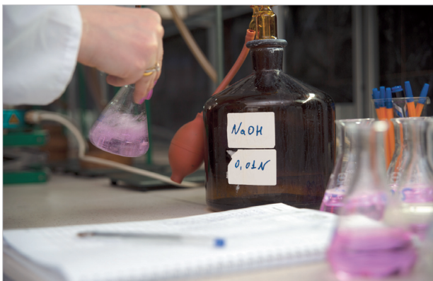
სურათი 43.2. აქროლადი მუგების ტიტრაციის საბოლოო ეტაპი (გამჭვირვალე ხსნარი გახდა ვარდისფერი)
