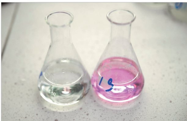
სურათი 43.3. აქროლადი მუგების შემცველი ხსნარი გატიტრამდე (გამჭვირვალე) და გატიტრის შემდეგ (ვარდისფერი)
