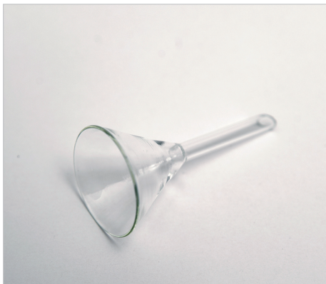
სურათი 34: მინის ძაბრი / Glass Funnel (სხვადასხვა ზომის, 50 მმ-100 მმ)
