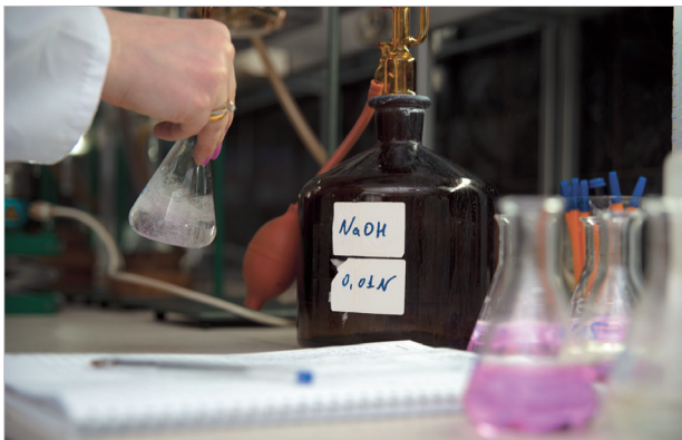
სურათი 43.1. აქროლადი მუგების ტიტრაციის საწყისი ეტაპი (ხსნარი უფერულია, ანუ ფერი ჯერ არ იცვლება)
