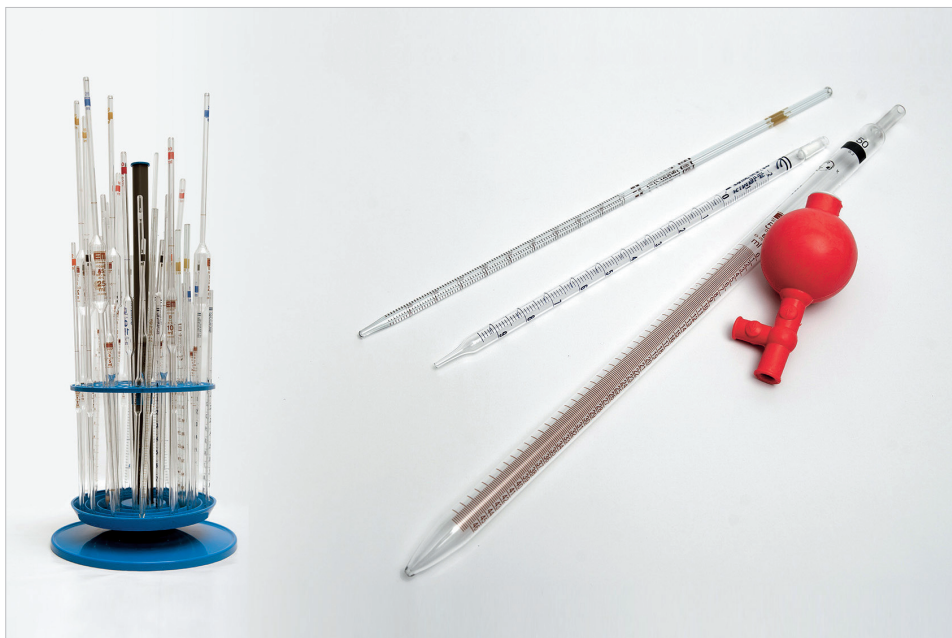
სურათი 14: მინის პიპეტები და პიპეტზე დასამაგრებელი რეზინის ბურთი შეწოვისთვის / Glass Pipettes and Rubber Suction Ball (სხვადასხვა მოცულობის)
