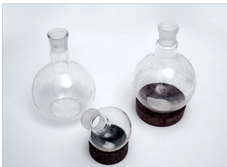
სურათი 30: მრგვალძირა კოლებები / Round Bottom Glass Flasks (250 მლ, 500 მლ, 1000 მლ)
