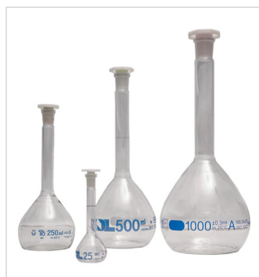
სურათი 16: გამზომი კოლებები / Measuring Flasks (სხვადასხვა მოცულობის)
