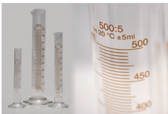
სურათი 15: მენზურა / Volumetric Glass Tube (სხვადასხვა მოცულობის, შკალის თავზე მითითებულია ტემპერატურა, რომელზედაც დაკალიბრებულია გამზომი ჭურჭელი)
